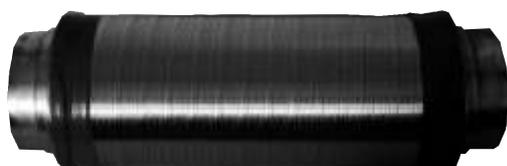
Der Außenmantel des Rohrschalldämpfers besteht aus einem Wickelfalzrohr, der innere Mantel wird aus Lochblech gefertigt. Zwischen den beiden Mänteln befindet sich eine Isolierschicht aus Glaswolle mit fadenverstärktem Glasvlies. Das Glasvlies verhindert das Eindringen von Glaswolle-Partikel in den Luftkanal. Die Steckstutzen der Endkappen sind mit Lippendichtungen versehen.
